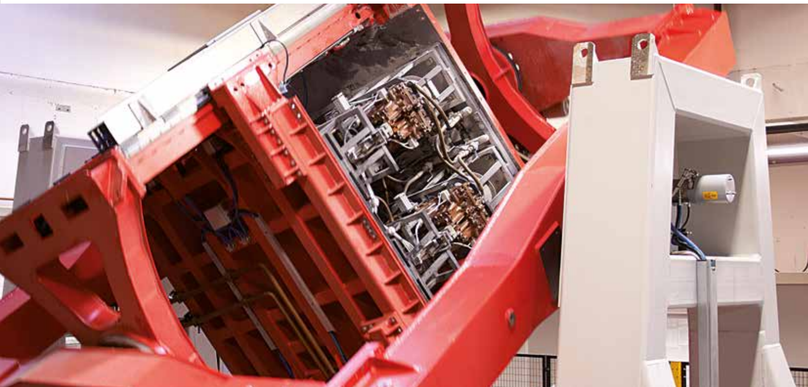
Rys. Rotacyjne urządzenie do spiekania w zakładzie 2, w Illertissen
